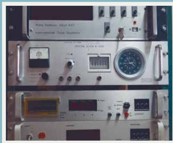
Figura 1. Antigua unidad de tiempo de la EARG. Permitía la datación de las observaciones con una exactitud de una diezmilésima de segundo. Se utilizó hasta 1999. Actualmente la Estación continúa con la misión fundacional pero con técnicas satelitarias GNSS y Doris.
