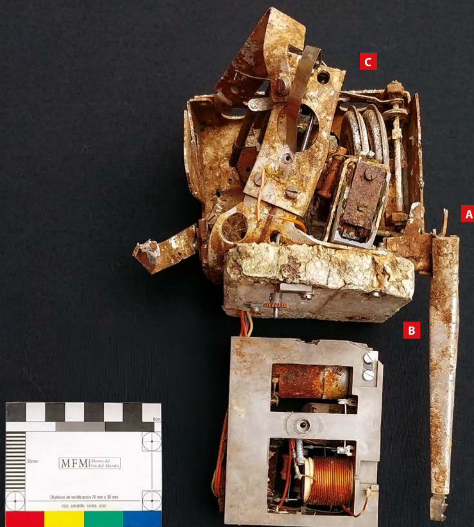
FIGURA 5. Arriba se observa la caja metálica que corresponde a la sección de registro y codificación de datos atmosféricos y abajo la caja plástica que corresponde al radio transmisor. A. Sensor de humedad; B. Carcasa de poliestireno expandido; C. Sensor de presión atmosférica.
