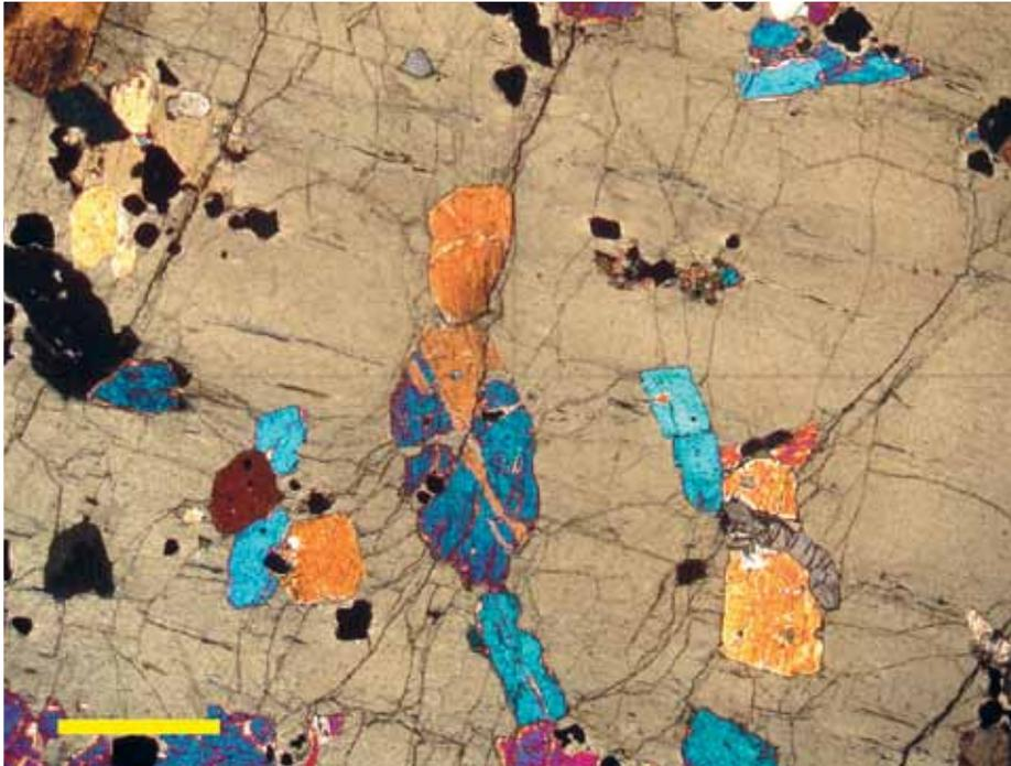
Hornblendita, roca de la Sierra Lucio López. Así se ve una roca ígnea al microscopio con luz polarizada. La roca está compuesta por los minerales: hornblenda (abarca toda la foto, color beige), piroxeno (azul, naranja, violeta) y magnetita (negro). Preparado de 30 micrones de espesor. La barra representa 1 mm.
