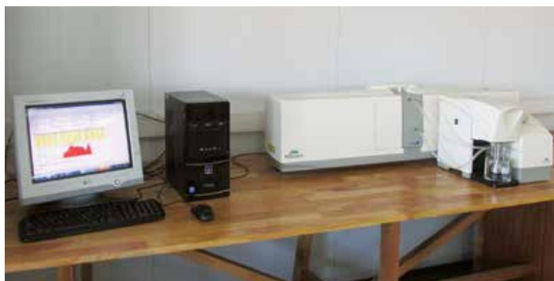
Imagen del Mastersizer 2000E y la PC con el software de Malvern
