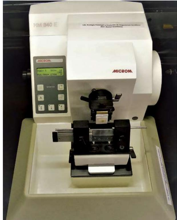
Figura 1. Micrótopmo de Rotación.
