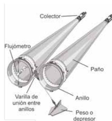
Figura 2. Esquema de una red Bongo marca Hydro-Bios y detalle de sus componentes.
