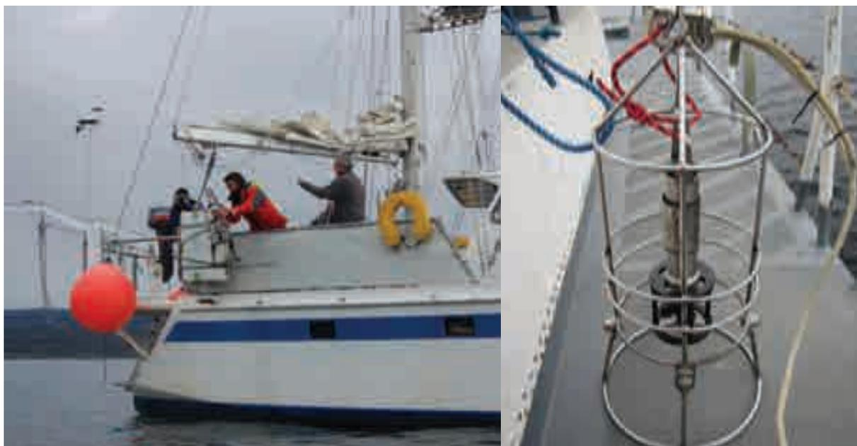
**Izquierda:** Operación de perfilado con el CTD, a bordo del "Quijote" ([www.syquijote.com](http://www.syquijote.com)), cortesía de Federico Guerrero. **Derecha:** CTD Rinko propiedad de CADIC. Se muestra montado en una estructura protectora de acero inoxidable, que lo protege de golpes y lo lastra para evitar que derive con las corrientes.
